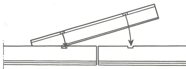
Fig. 5 - Jonction mécanique entre éléments par couvre-joint VE 304
