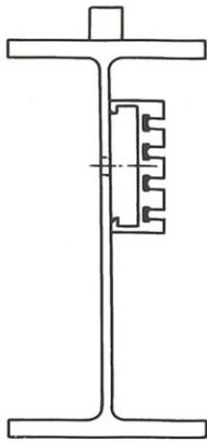
Fig. 1 - Montage sur rail de pont roulant.
