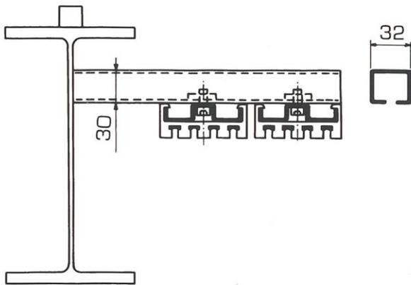
Fig. 2 - Montage sur rail de pont roulant, par supports.
