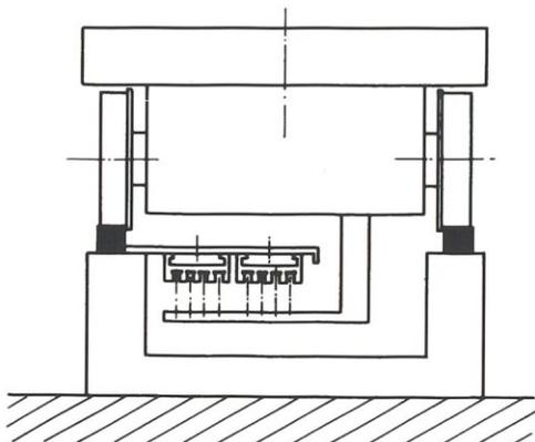
Fig. 4 - Montage sur ossature d'une ligne de convoyeur
