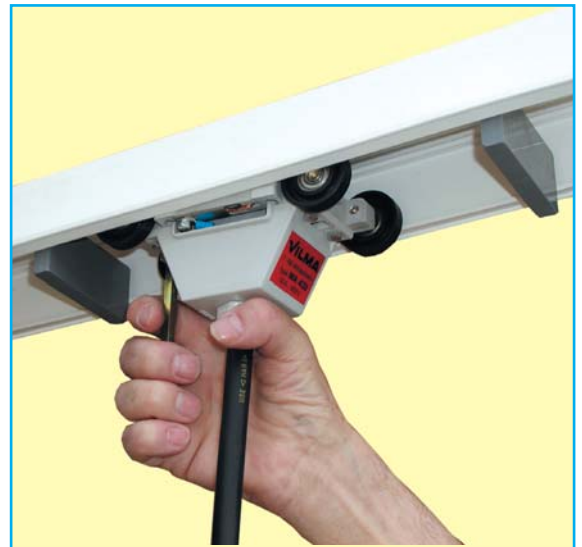
Fig. 1 - Extraction en cours de ligne du chariot-collecteur.
