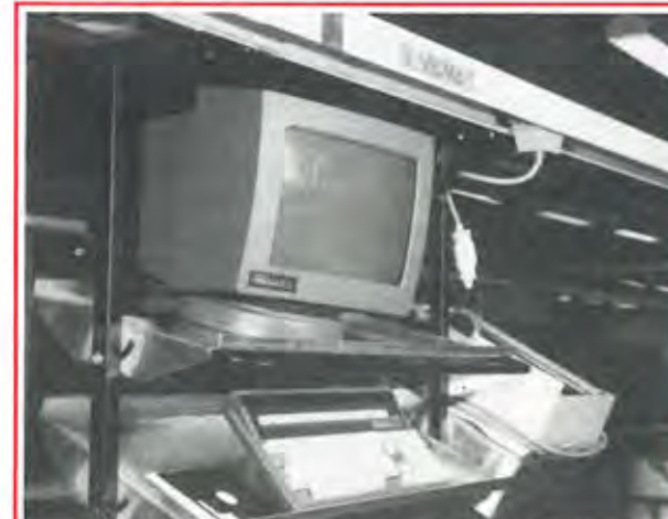
Abb. 3 Stromzuführung zur elektrischen Prüfung von Fernsehgeräten in der Endabnahme.
