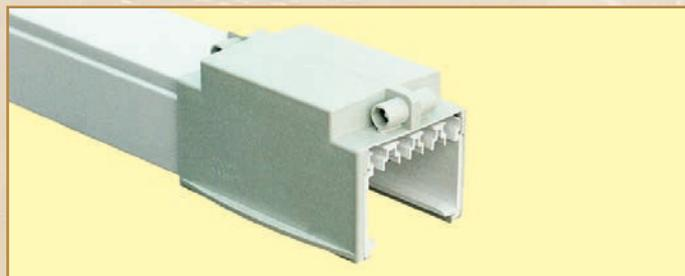
Fig. 6 - Tête d'embranchement TE.VA 4. Passage du chariot collecteur d'une voie sur une voie opposée. Tolérances d'alignement  $\pm 2$  mm en vertical et latéral.
